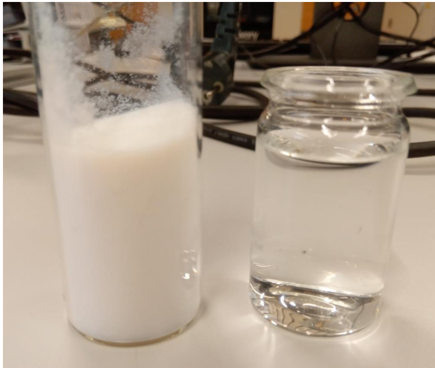
Abbildung 10: Dry Water und Wasser im Vergleich; links: Dry Water mit 25 ml Wasser und einem SiO 2 -Anteil von 5 %; rechts: 50 ml destilliertes Wasser.
