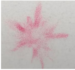
Abbildung 36: Druckbild einer Kugel mit Falten in den Folien
