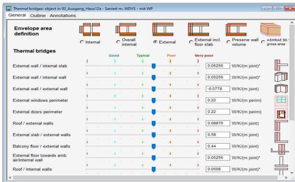
Abbildung 20: Wärmebrückenauslegung
