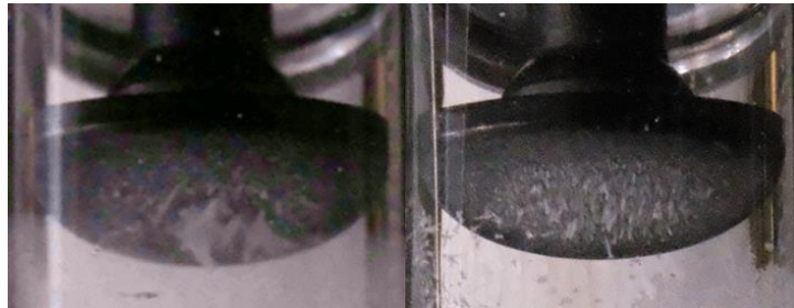
Abbildung 53: Ausbildung dendritischer Eiskristalle auf dem Substratteller von ausgewählten Vorversuchen. Die Kristalle bilden sich während das Substrat auf die Synthesezieltemperatur von T_t = -35\text{ °C} gefahren wird. Die Verdampfungstemperatur beträgt T_b = 20\text{ °C} . Der Reaktor ist mit dem \text{N}_2 + \text{CO}_2 Gasgemisch gespült und es herrscht Atmosphärendruck während sich die Kristalle bilden.
